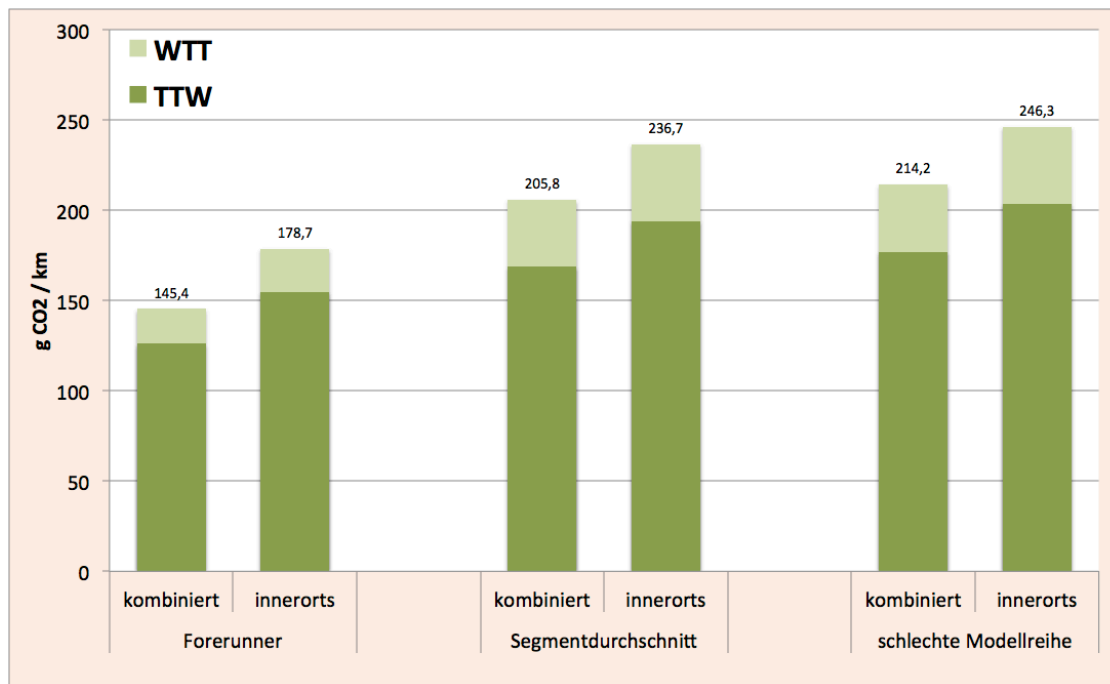
Abbildung 14 Spezifische CO 2 -Emissionen im kombinierten und im innerörtlichen Fahrzyklus mit den Vorketten für ein emissionsarmes Modell, den Segmentdurchschnitt und die emissionsstärkste relevante Modellreihe im Jahr 2010 im Segment kleine leichte Nutzfahrzeuge
